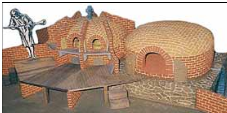
Abbildung 31: Modell eines Böhmisches Glasofens des 18. Jahrhunderts im Waldgeschichtlichen Museum in St. Oswald. Links der Schmelzofen, rechts der Kühlöfen. Foto: Steger
